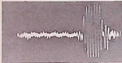
Afb. 11. Oscilloscoopbeeld van het uitgangssignaal van de converter, waarbij de minimum amplitude wordt onderbroken door de maximum amplitude. Gedurende de registratie wordt slechts tijdens de maximumamplitude een zwart puntje afgebeeld.
